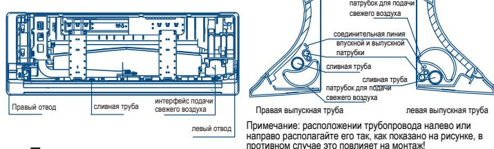
Примечание: расположение трубопровода налево или направо располагайте его так, как показано на рисунке, в противном случае это повлияет на монтаж!
