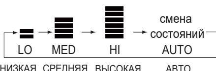
Кондиционер работает с отображением скорости работы вентилятора.
