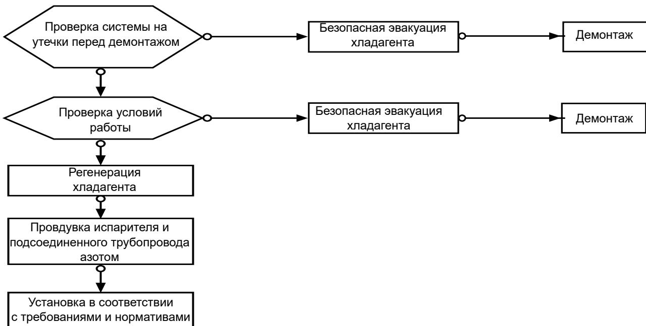
1. Проверка герметичности системы на наличие утечек перед демонтажом.
