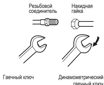
Чрезмерное усилие затяжки при отсутствии центровки может привести к повреждению резьбы и утечкам хладагента.
