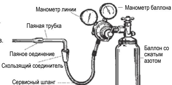
При 24-х часовой опрессовке следует учитывать, что изменение наружной температуры на 1°C соответствует изменению давления в системе на 0.01 МПа (0,1 кгс/см<sup>2</sup>), поэтому его необходимо уравнивать до нужного уровня в течение всего хода испытания.
