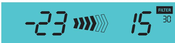
Рисунок 5.6 — Вид ЖК-дисплея, когда прибор находится в режиме ручного управления и приближается срок замены фильтров
