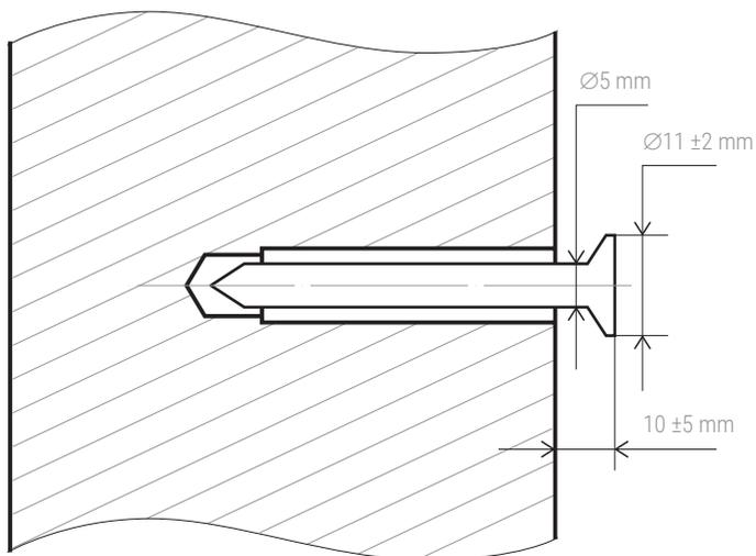
Рисунок 6.4 – Сверление отверстия для анкерных болтов
