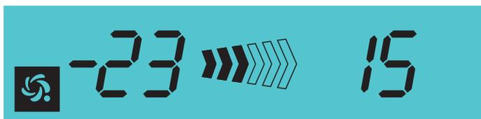
Рисунок 5.5 — Вид ЖК-дисплея, когда прибор подключен к базовой станции системы MagicAir и находится в режиме ручного управления
