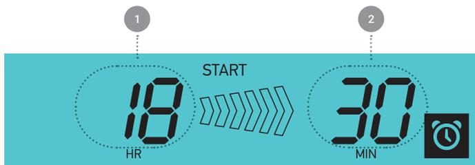
Рисунок 5.15 – Настройка времени включения устройства
