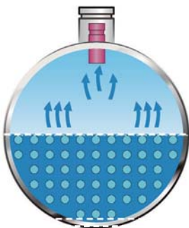
Испаритель затопленного типа
