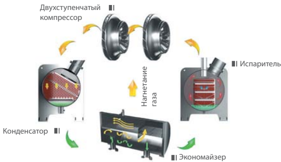
Схема технологии двухступенчатого сжатия
