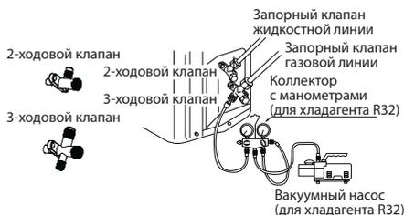
2. Откройте ручку низкого давления коллектора с манометрами и включите вакуумный насос. Если стрелка манометра (низкого давления) сразу же укажет на вакуум, повторите шаг 1 еще раз.
