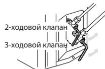
7. Чтобы предотвратить утечку газа, поверните колпачок сервисного порта и колпачки штоков 2-ходового и 3-ходового клапана несколько дальше после резкого увеличения усилия.
